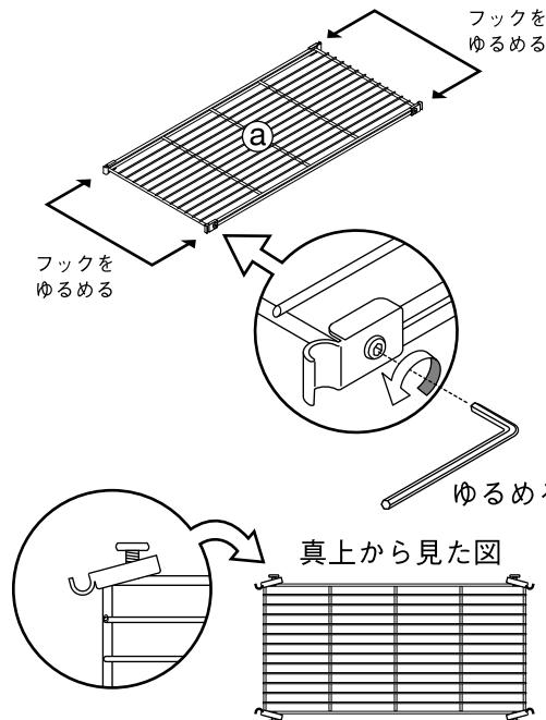
※棚の全てのフックのネジが上図のような状態になるまでゆるめ、フックがハの字になるようにしてください。
