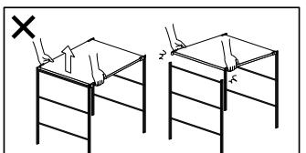
■組立て後の移動は必ず収納物を取り除いてから2名以上で左右から帆立部分をしっかりと持って慎重に移動してください。棚がはずれて物が落ち、思わぬケガや器物破損の原因になることがあります。
