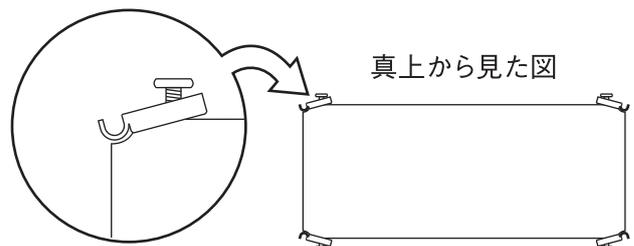
※棚の全てのフックのボルトが上図のような状態になるまでゆるめ、フックがハの字になるようにしてください。
