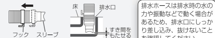
排水ホースは排水時の水の力や振動などで動く場合があるので、排水口にしっかりと差し込み、抜けないことを確認してください。
