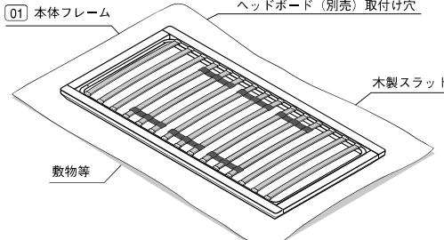
[2] [01] 本体フレームは下図のように裏返し、本体フレーム内のコーナー部にある脚取付け穴に[02]脚をねじ込み、しっかりと取付けます。※敷物をした状態ですが、裏返す際に木製スラットや床面を傷つけないように十分注意してください。
