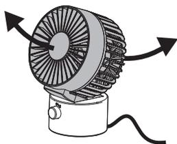
風向可由水平方向向上調整至約30度的範圍。調整時請以單手扶住底座再調整。調整前，請務必確認開關切換於「0」（關）的位置。※於扇葉旋轉時移動前後網罩，可能導致扇葉與網罩碰觸。
