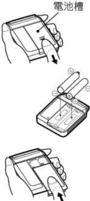
電池壽命隨使用頻率、使用狀況等而異，3號鹼性乾電池於1日1次約3分鐘/室溫(約20°C)的使用情形下壽命約4週。
