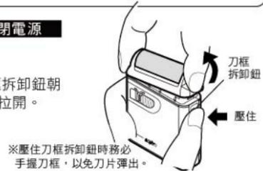
※壓住刀框拆卸鈕時務必手握刀框，以免刀片彈出。
