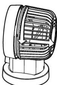
移除USB插頭，依照箭頭方向轉動後網罩再向後方取下網罩。
