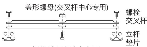
※请将各交叉杆的朝向如上图所示叠放。将螺栓从平坦面穿过, 使用盖形螺母将凹陷面轻轻旋紧。此外, 交叉杆无上下方向之分。
